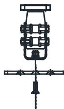
Na průchozích sloupech pro ocelovou střešní krytinu FA 60 220 00 nebo střešní krytinu se stojatou drážkou FA 60 223 00 za pomocí šroubu s šestihranou hlavou M12 × 25 mm a podložek M12 (dodávají se s průchozími sloupy).
